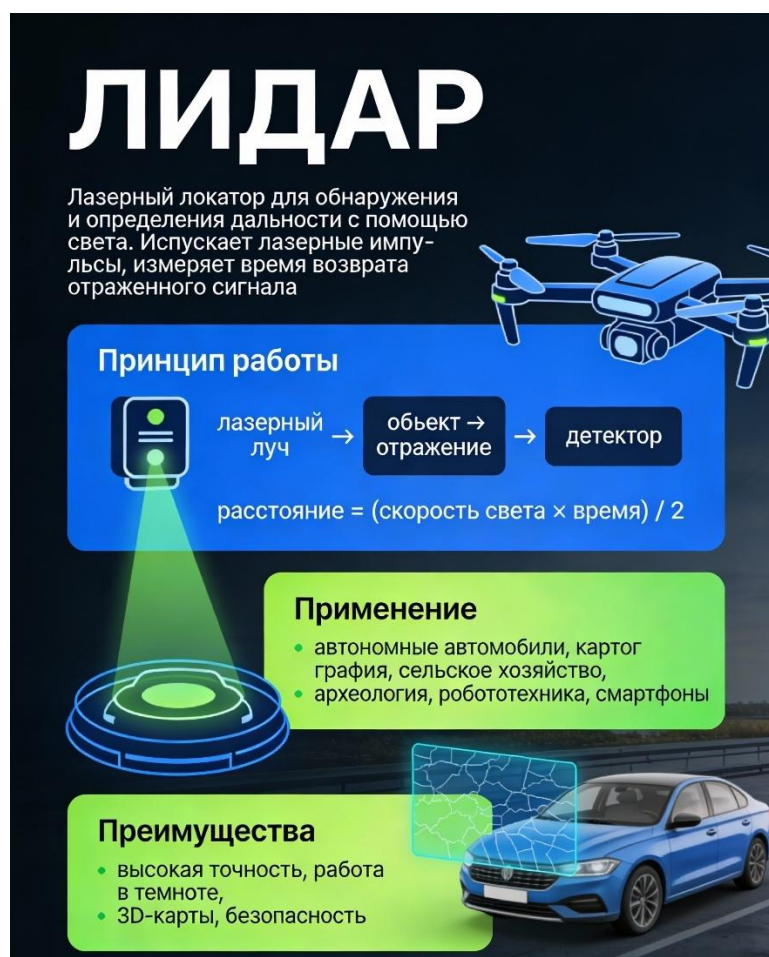
Рисунок 5.4 – Принцип работы системы «ЛИДАР»
